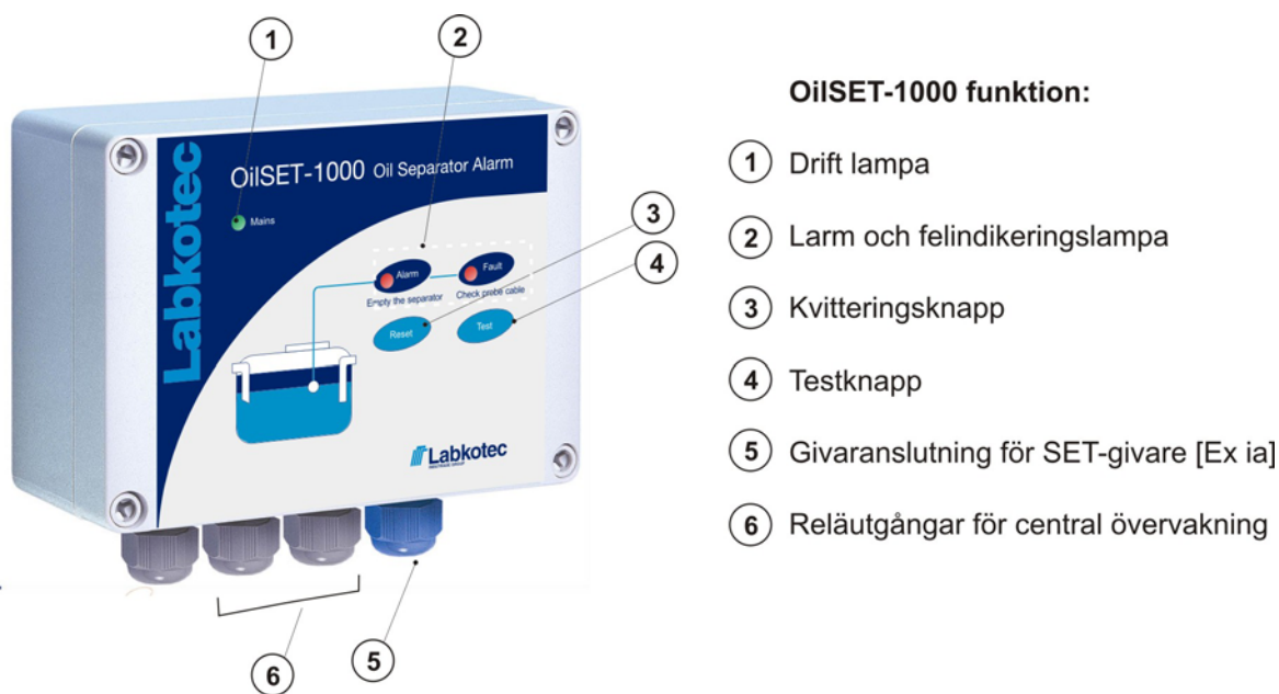
Figur 2. OilSET-1000 centralenhetens funktion
